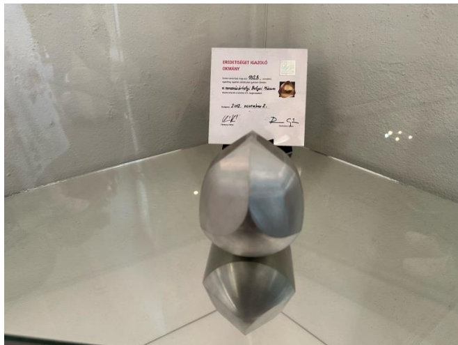
Gömböc: Egy konvex test, aminek csak 1 stabil pontja van (Forrás: saját kép)
